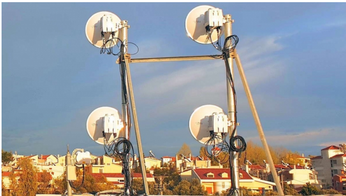
На фото испытания 10-гигабитных РРЛ на трассе 1.5 км. Источник: Deutsche Telekom
