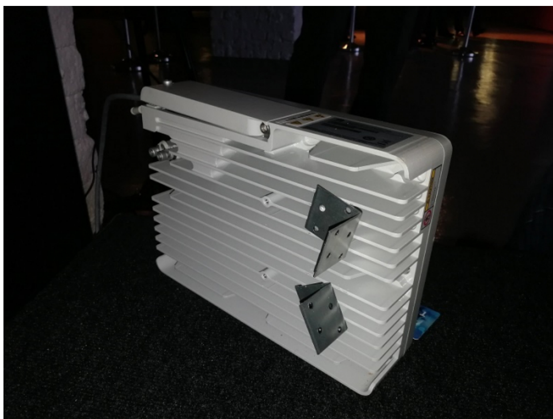
Базовая станция gNodeB Huawei
