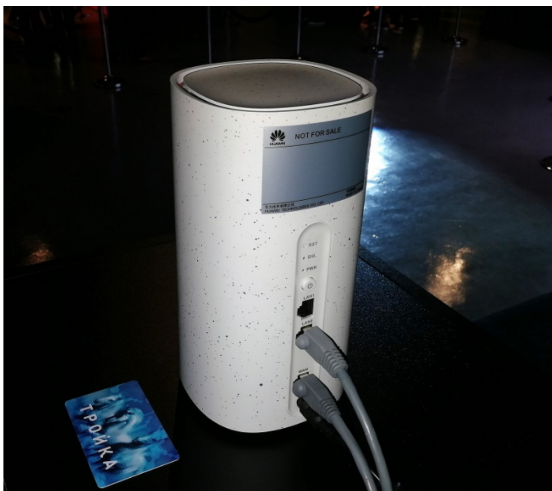
5G CPE на Huawei Balong5G01 (RF-модуля (ODU) и 5G/Wi-Fi-роутер (IDU))
