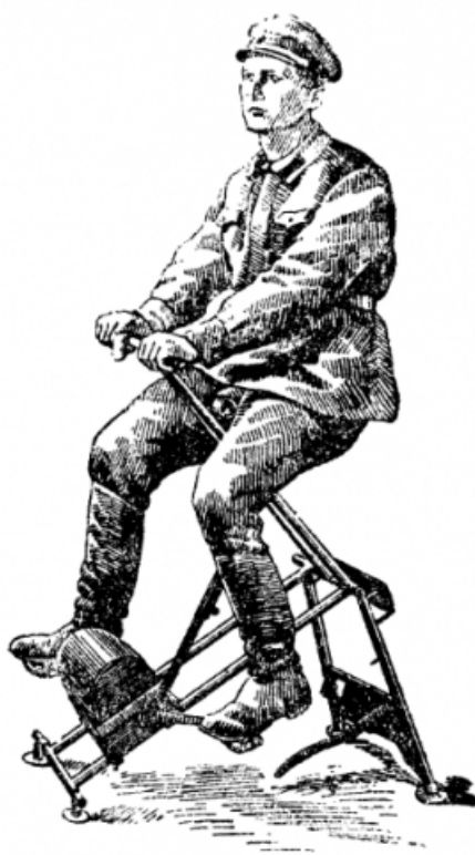
Рис. 104. Динамомашинa с ножным приводом в развернутом виде в работе
