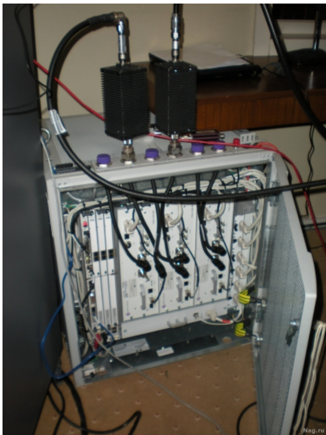
Демонстрационный образец базовой станции, приемо-передатчик для диапазона 700 МГц
