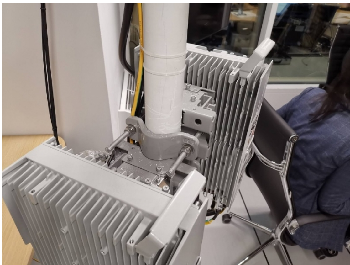
С правой стороны трубостойки - радиомодуль LTE Huawei RRU5909 RRU.SFP.9800.DC / B03-1800.Z.120.2T2R. С левой стороны - блок питания Huawei OPM50M.
