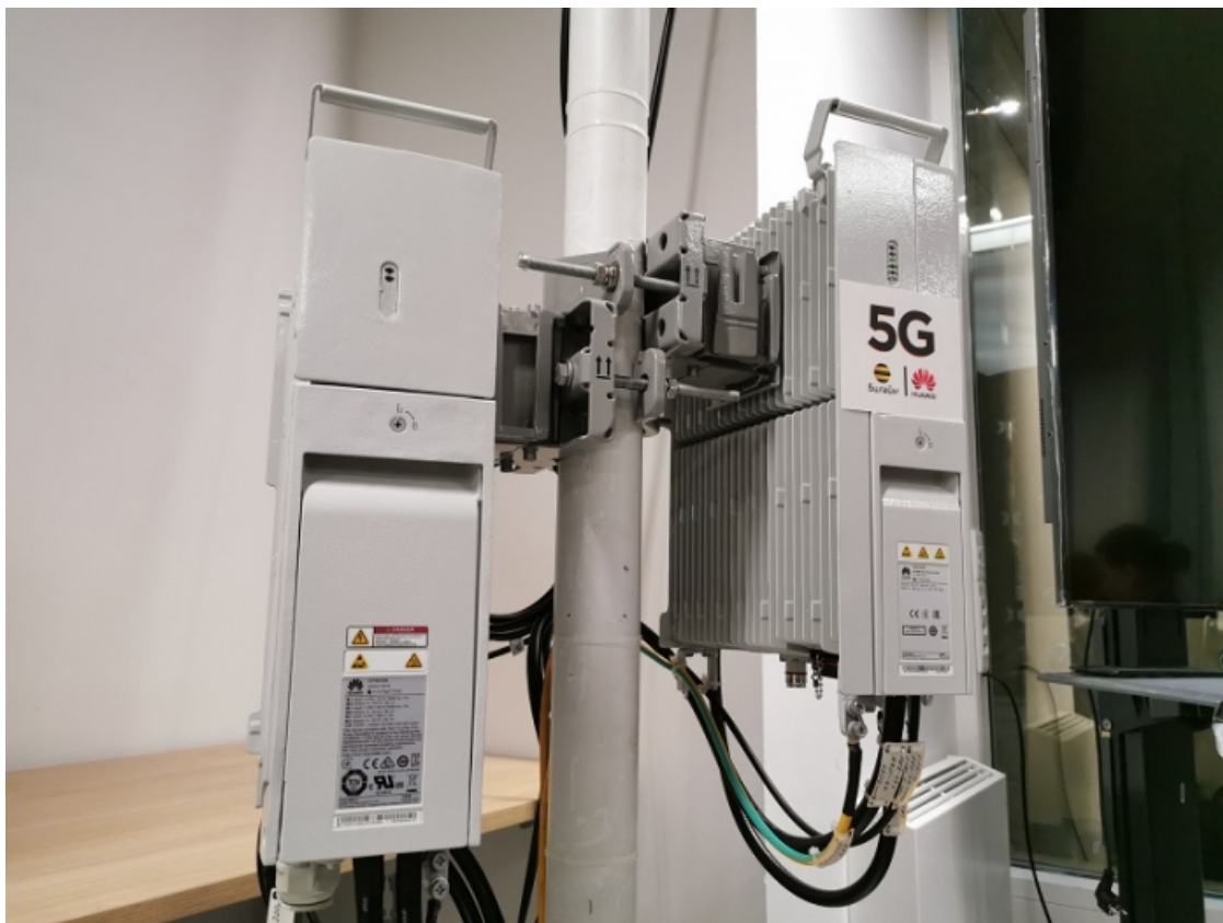
С правой стороны трубостойки - радиомодуль LTE Huawei RRU5909 RRU.SFP.9800.DC / B03-1800.Z.120.2T2R. С левой стороны - блок питания Huawei OPM50M.
