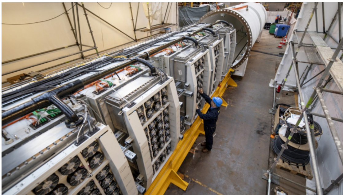
Инженеры внедрили стойки серверов Microsoft и связанную с ними инфраструктуру системы охлаждения в центр обработки данных.
