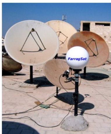
Рис. 8 – Компактная ЛЛ, заменяющая 4 параболические антенны
