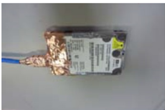
Рисунок 9 – Экранирование на HDD-коннекторе, всех областей печатной платы и частично корпуса (case 3)
