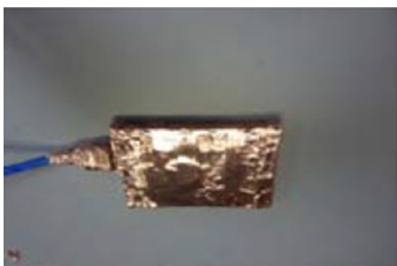
Рисунок 10 – Полное экранирование на HDD-коннекторе, печатной платы, корпуса (case 4)
