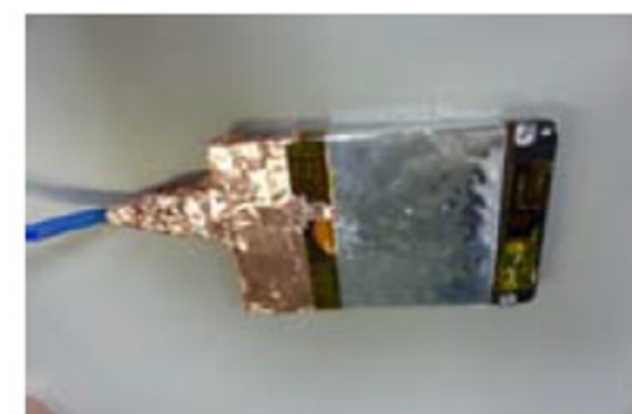
Рисунок 9 – Экранирование на HDD-коннекторе, всех областей печатной платы и частично корпуса (case 3)
