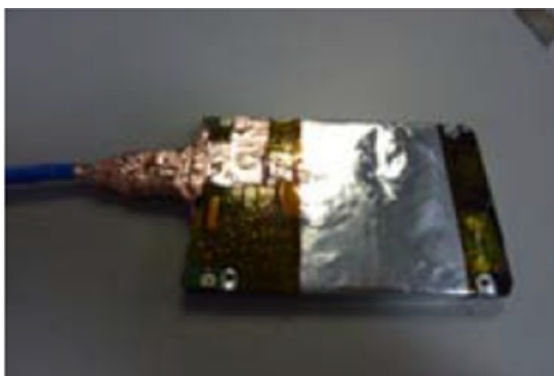
Рисунок 8 – Экранирование на HDD-коннекторе и небольшого участка печатной платы вокруг него (case 2)
