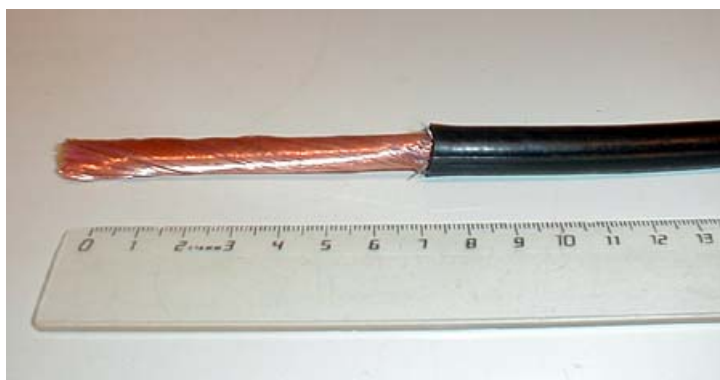
Кабель со снятой броней и внешней оболочкой. Хорошо виден добротный медный экран.
