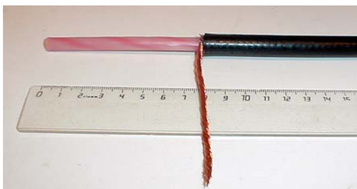
Кабель со снятой броней и внешней оболочкой. Хорошо виден добротный медный экран.
