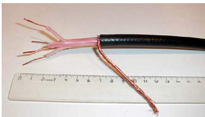
Разделанный кабель. Для приведения кабеля в такой вид нужен хороший нож.
