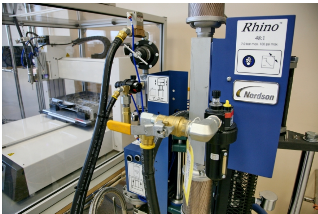
Подача термогеля в роботизированную систему
