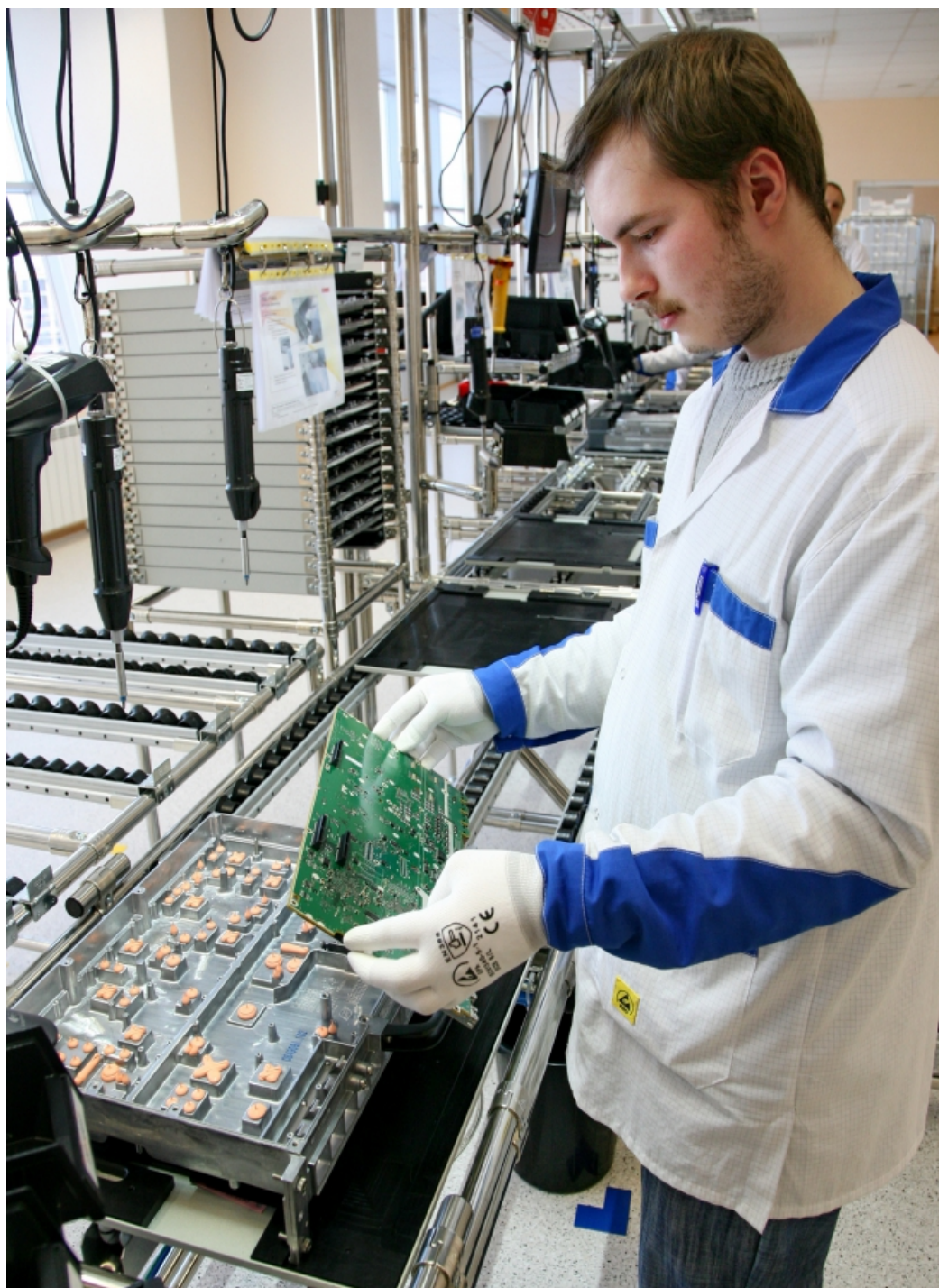
Совмещаем, ставим платы в корпус системного модуля
