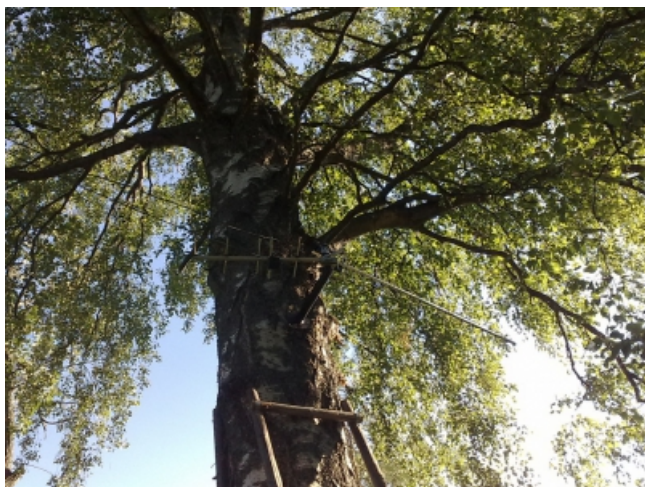
Антенный пост на дереве: направленная антенна CDMA покоре и смотрит "влево", антенна GSM подлиннее и смотрит "вправо". Фото пользователя nodong.
