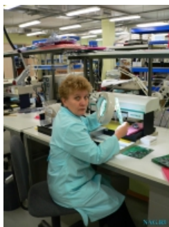
Пост полуавтоматического монтажа компонентов на печатные платы
