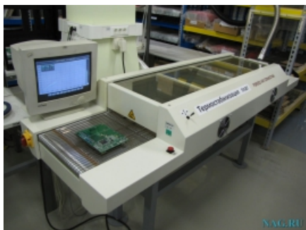
Специальная линия для термостабилизации плат
