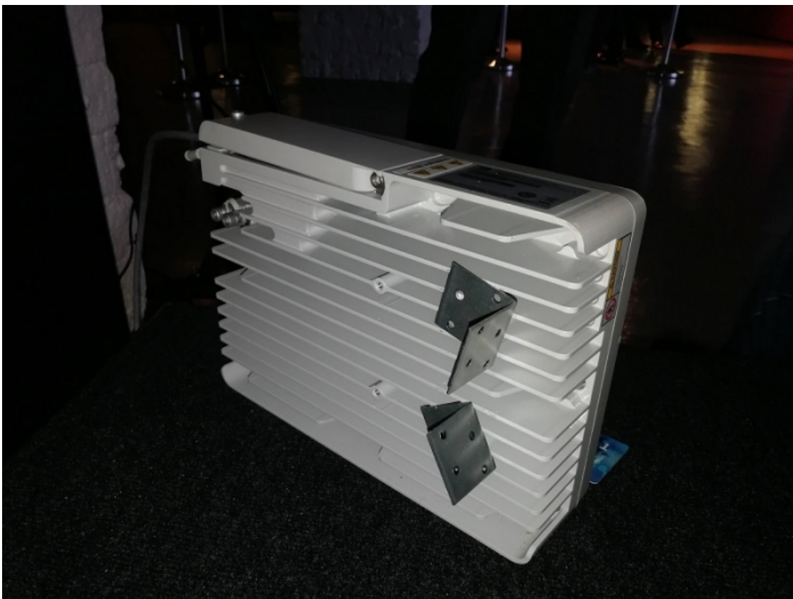
Базовая станция gNodeB Huawei
