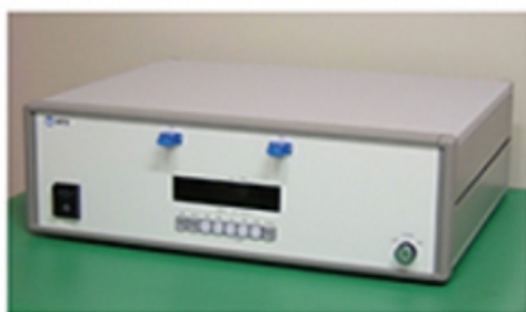
Внешний вид усилителя размеры 430x350x132.5 мм
