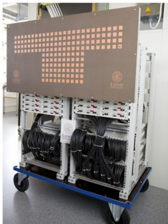
Рисунок 6 – Практическая реализация M-MIMO в Университете Lund в Швеции на основе оборудования USRP RIO (слева) и кросс-поляризованной антенной решетки (справа)
