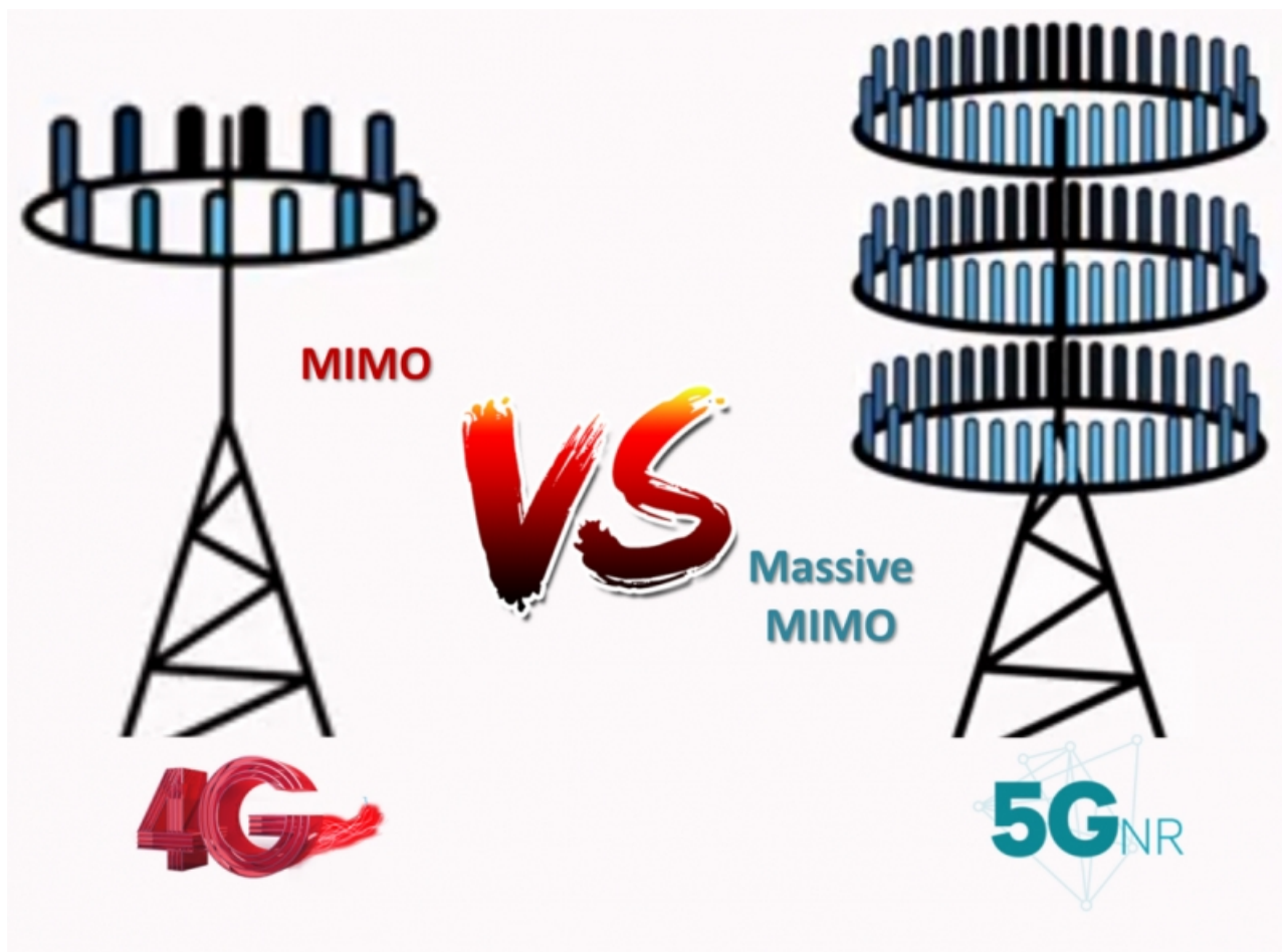
Рисунок 2 – Наглядное сравнительное представление технологий MIMO и Massive MIMO
