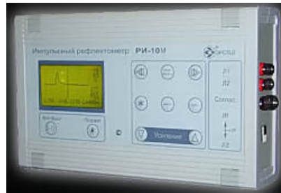
РИ-10М. Современный рефлектометр (кабельный тестер) отечественного производства.
