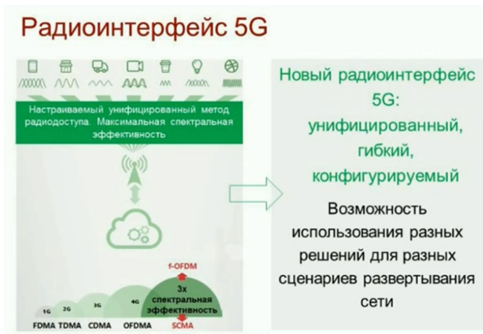
Рисунок 5 - Концепция нового радиоинтерфейса
