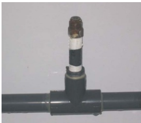
Рис 11. Слева: форсунка для распыления воды (дождь), справа: форсунка солевого тумана
