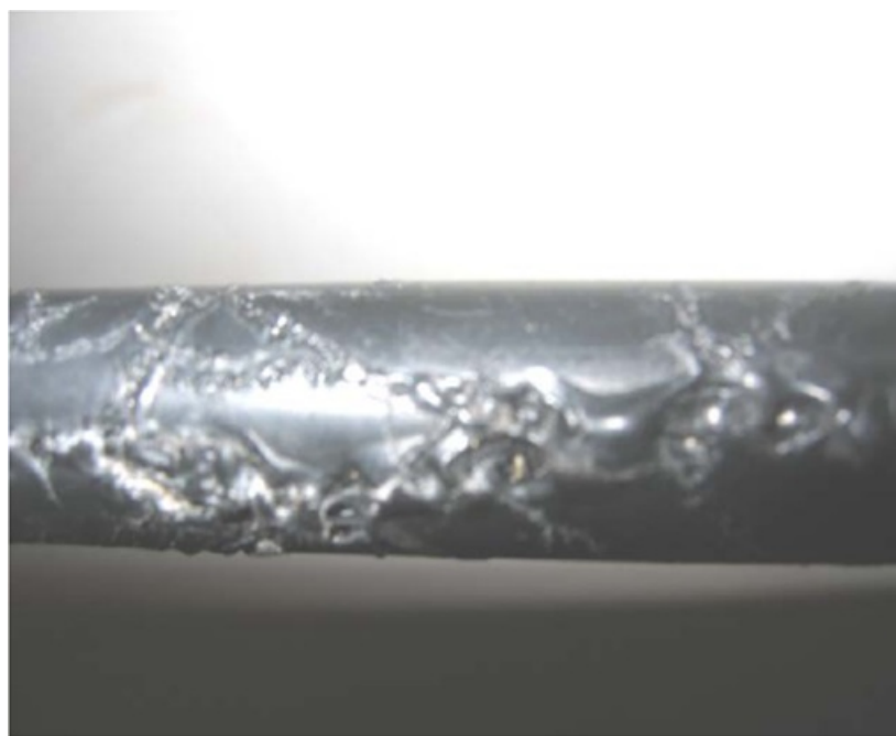
Рис. 13 Повреждения оболочки испытуемого ОК ADSS
