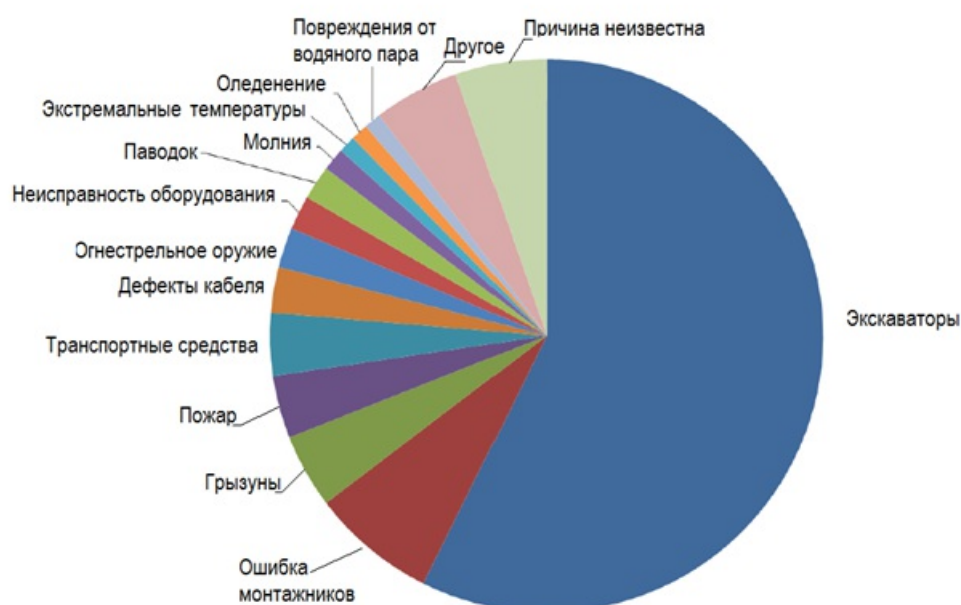
Рис. 1 Статистика причин повреждений и простоев в работе ВОЛС
