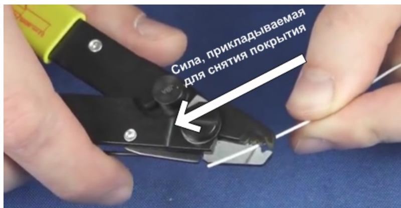
Рис. 2 – К пояснению предельно допустимой силы для снятия защитного покрытия
