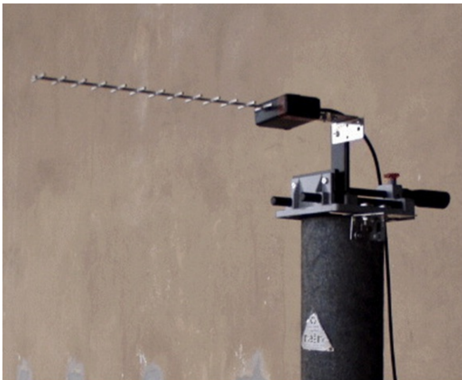
Рис. 4 – Одна из используемых антенн типа "волновой канал"
