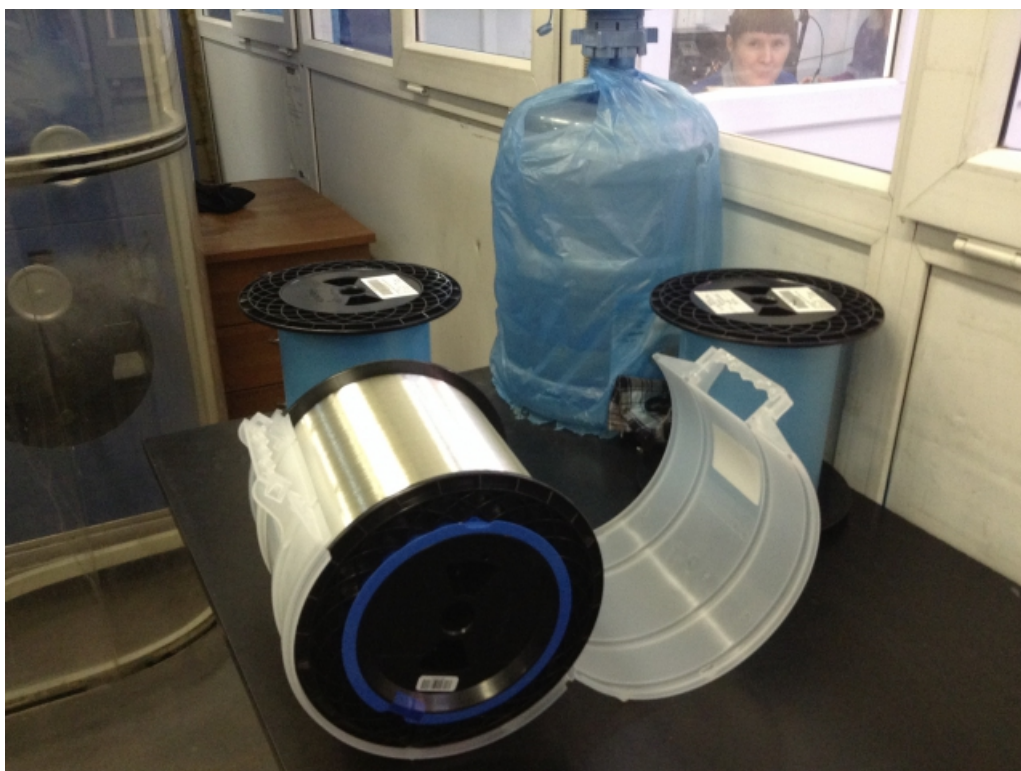
Еще не покрашенное оптоволокно Corning
