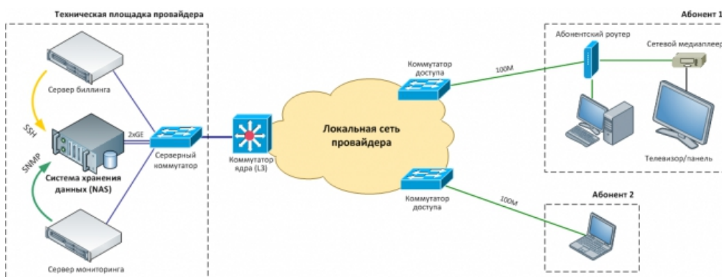
Рис.1 – Интеграция NAS в сетевую инфраструктуру Ethernet-провайдера
