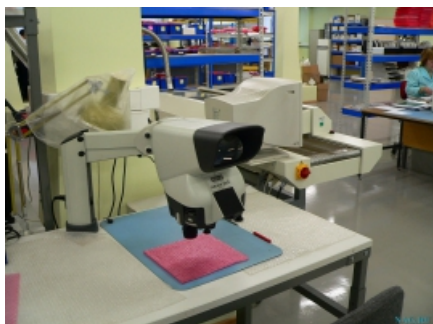
Внешний вид рабочего поста с микроскопом Mantis
